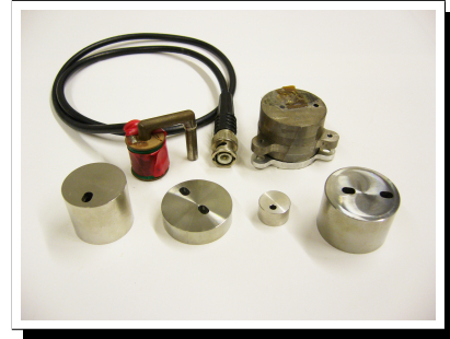
Abbildung 1: MATs in verschiedene Formen und Größen, Material Vacoperm
