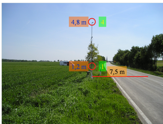
Abbildung 1: Messanordnung für Vorbeifahrtmessung mit vier Mikrofonen. Für die Berechnung der Kohärenz werden die Höhen 1,2 m (gemäß ISO 11819-2) und 4,8 m in 7,5 m Entfernung von der Mitte der Fahrspur verwendet. Das Bild stammt von der B 56, einer Versuchsstrecke der BASt im Rahmen des Projektes "Leiser Straßenverkehr"
