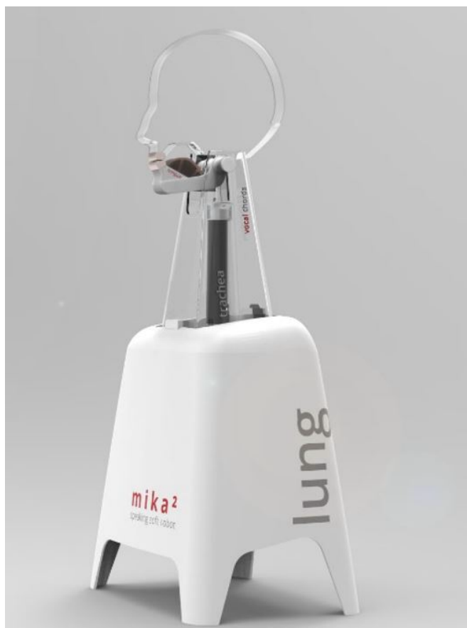
Abbildung 3: Sprechapparat mika 2 als Forschungsplattform.
