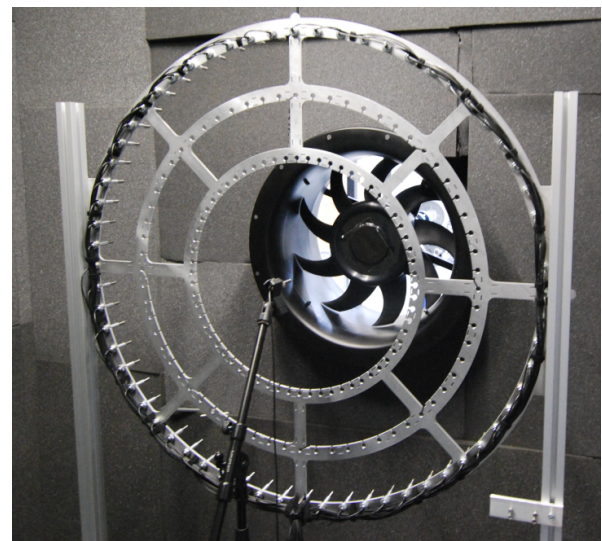
Abbildung 7: Messaufbau des untersuchten Ventilators mit Ringarray. Das axial mittige Mikrofon wird nicht verwendet.
