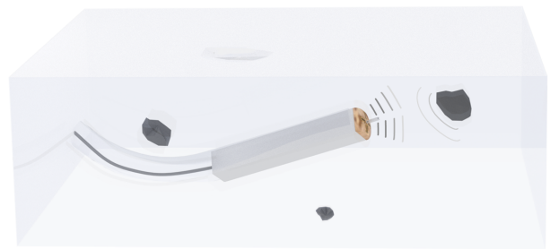
Abbildung 2: Arbeitsprinzip der akustischen Vorfelderkundung
