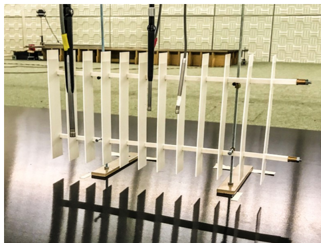
Abbildung 6: Das mobile Fassadenlabor in der HaMt im Maßstab 1:10. Die Fassadevariante "90 Grad geöffnete Lamellen" ist aufgebaut
