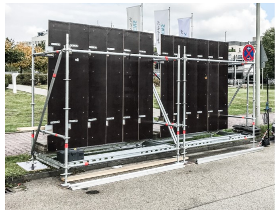
Abbildung 2: Das mobile Fassadenlabor in der geschlossenen Grundstellung "Referenzfläche" neben der Fahrbahn
