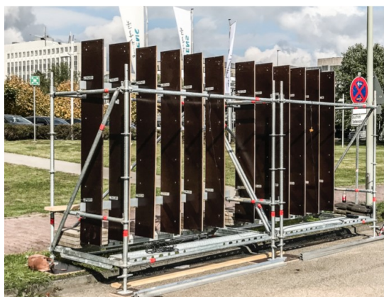
Abbildung 3: Die Testfläche des Fassadenlabors in der Stellung "90 Grad geöffnete Lamellen"
