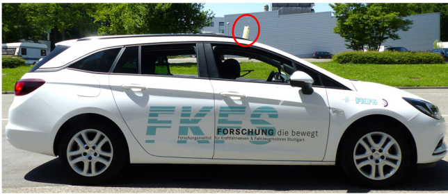
Abbildung 3: Versuchsfahrzeug mit Cobra-Sonde auf dem Dach (rot markiert) und Kunstkopf auf dem Beifahrersitz
