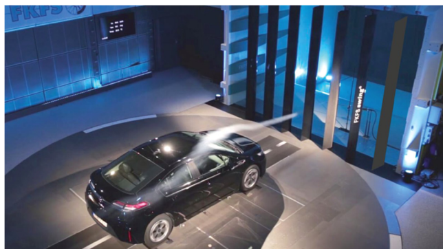
Abbildung 2: Aktiver Böengenerator FKFS swing ®
