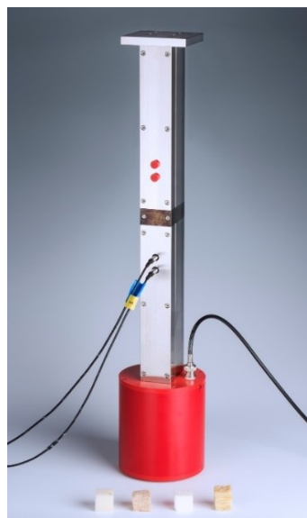
Abbildung 2: Foto des kleinen Transmissionsrohrs inklusive einiger würfelförmiger Proben mit 2 cm Kantenlänge
