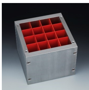
Abbildung 13: Segmentierter Probenhalter für das große Transmissionsrohr
