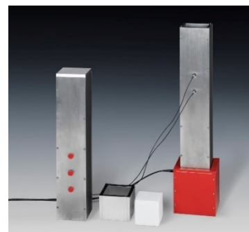
Abbildung 3: Foto des großen Transmissionsrohrs, links: oberer Teil; Mitte: Probenhalter und 10 cm Würfelprobe; rechts: unterer Teil
