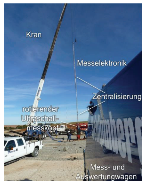
Abbildung 1: Foto des Ultraschallmessaufbaus in einer Feldmessung, bevor das Messgerät in das Bohrloch abgelassen wird.
