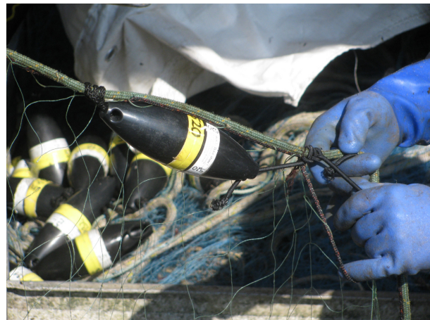
Abbildung 19b: PAL-Geräte in ein Fischernetz eingebaut [12, 13]
