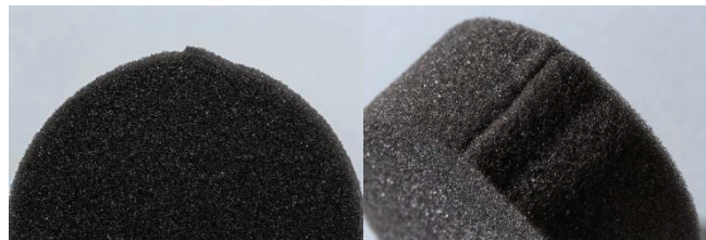
Abbildung 6: möglicher ausgeprägter Anschnitt mit Ausprägung einer „Nase“ beim Sägezuschnitt [Bild: Fraunhofer LBF]
