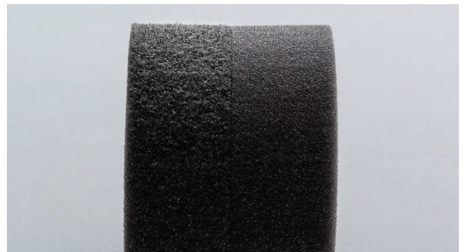
Abbildung 3: verschiedene Schnittflächen durch verschiedene Zuschnittsverfahren (links: Bandsäge, rechts: Wasserstrahl) [Bild: Fraunhofer LBF]
