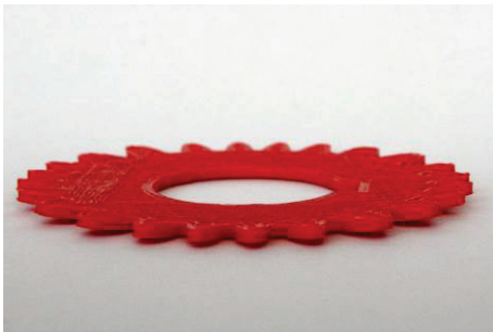
Abbildung 3: durch thermische Schrumpfung verzogenes ( warping ) und daher unbrauchbar gewordenes Bauteil
