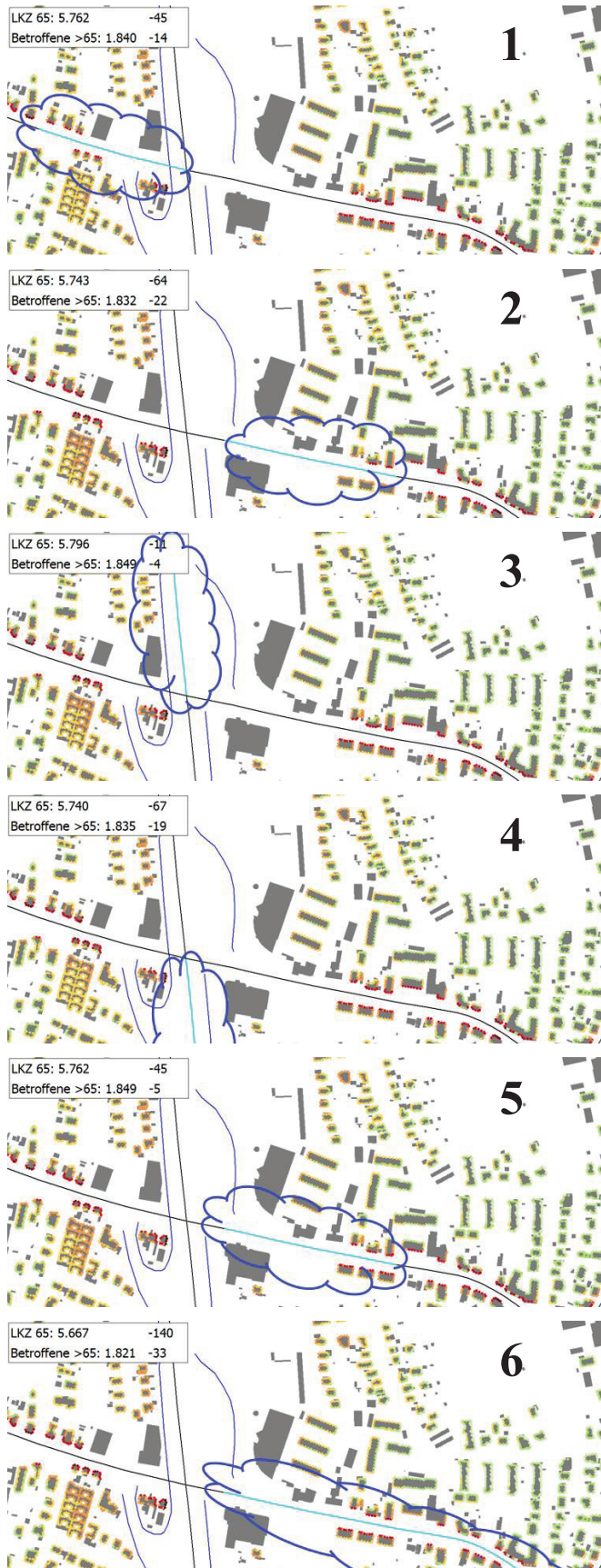
Abbildung 3: Ausgangssituation (1) mit Angabe der LKZ sowie der Betroffenen >65 dB(A) LDEN; manuelle Auswahl einzelner Straßenabschnitte, Ansatz einer Emissionsminderung von pauschal 5 dB (2-5); Auswahl zweier Abschnitte mit Ansatz „Tempo 30“ (6)
