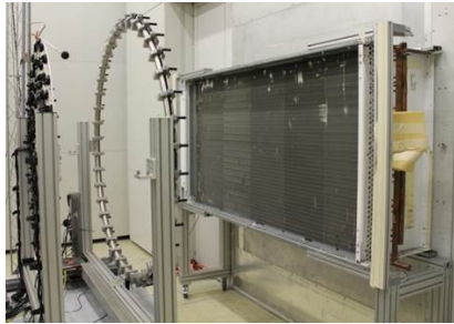
Abbildung 3: Messaufbau mit saugseitig montiertem Wärmetauscher.
