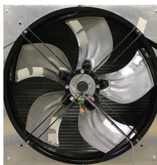
Abbildung 5: Axialventilator mit wechselbaren Vorderkanten.
