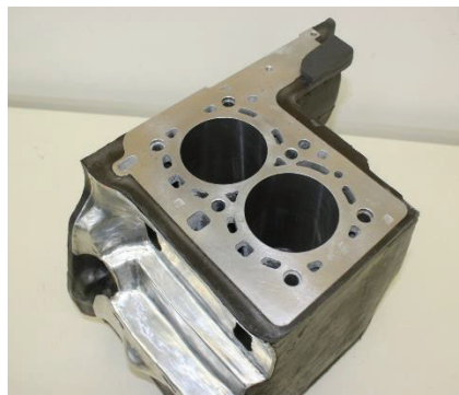
Abbildung 5: Zylinderkurbelgehäuse des Versuchsträgers nach dem Einschäumprozess
