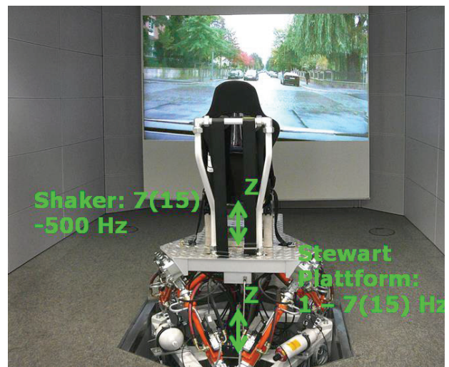
Abbildung 5: Wiedergabesystem über das die GKS-Stimuli präsentiert wurden, bestehend aus einer Stewartplattform und einem elektrodynamischen Shaker
