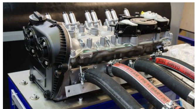
Abbildung 2: Geschleppter Zylinderkopf zur Erzeugung des pulsierenden Massenstroms
