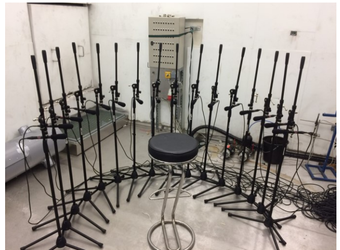
Abbildung 2: Aufbau zur Messung der Winkelabhängigkeit des Active Noise Cancelling-Effekts: Das Messobjekt wird in der Mitte eines Halbkreises aus 16 Messmikrofonen, welche paarweise mit dem Nachbarn immer den selben Winkel einschließen und äquidistant zum Zentrum aufgestellt sind, positioniert. Die Ventilatorachse befindet sich in der Mikrofonebene.
