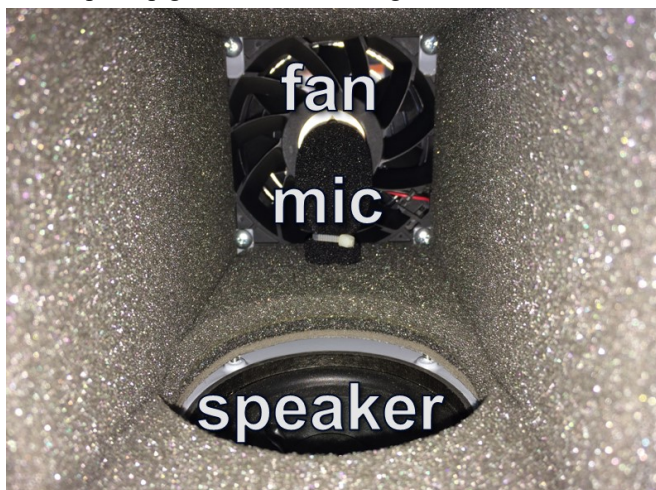
Abbildung 1: Prinzipaufbau der ANC Experimente zur Anwendung an Wärmepumpentechnologien: Als Störschallquelle fungiert ein Ventilator, als Aufnehmer des Referenzsignals ein Mikrofon unter einem Windschutz und als Gegenschallquelle ein Lautsprecher.
