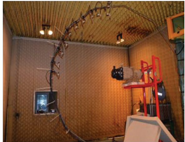
Abbildung 1: Aufbau der Messung der Richtcharakteristik für einen Axiallüfter in Anlehnung an DIN EN ISO 3382-1.
